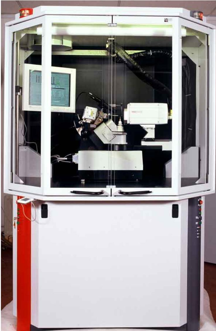
Bruker X8-Apex CCD Diffraktometer
